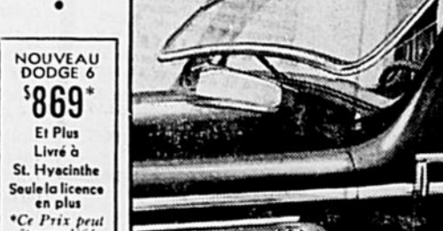
Les pare-brise Dodge s'ouvrent tout grand. Les ventilateurs d'avant font vers l'avant et sont munis d'une grille pour exclure les insectes.
