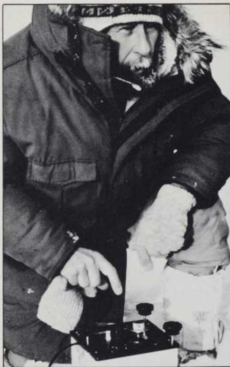
Hans Weber, directeur de l'expédition, effectuant des relevés gravimétriques qui serviront à élucider la structure et la densité de la croûte terrestre.
