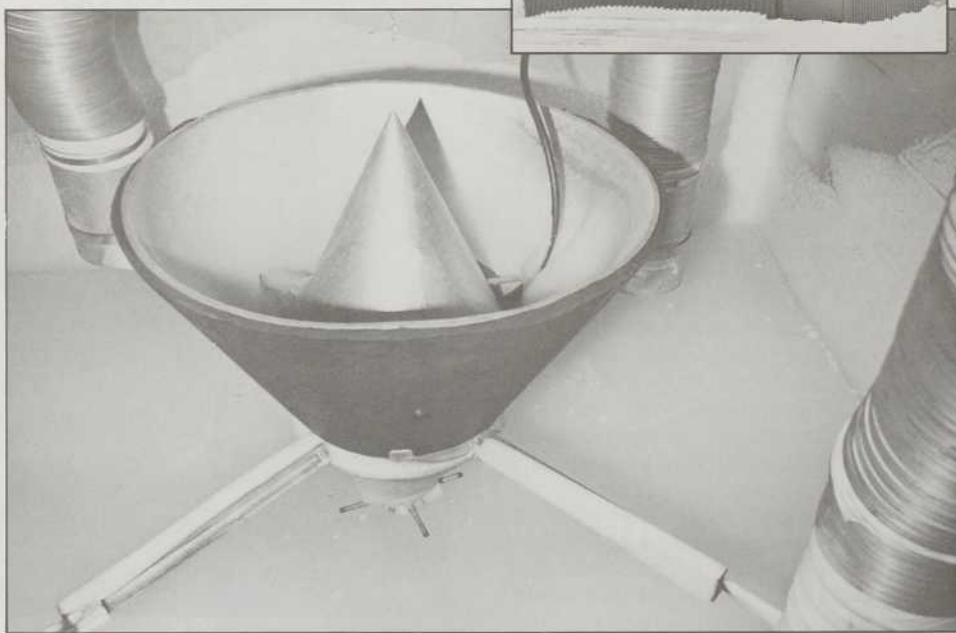
La Fabrikaglace: au-dessus du bloc de glace, un système simple amène l'eau et l'air froid qui la fera geler.
