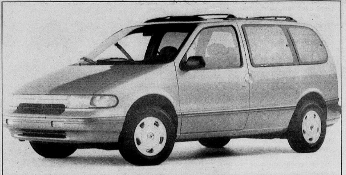
La Mercury Villager fait confiance aux mêmes éléments mécaniques que la Nissan Quest. Toutes deux reçoivent un V6 de trois litres.
