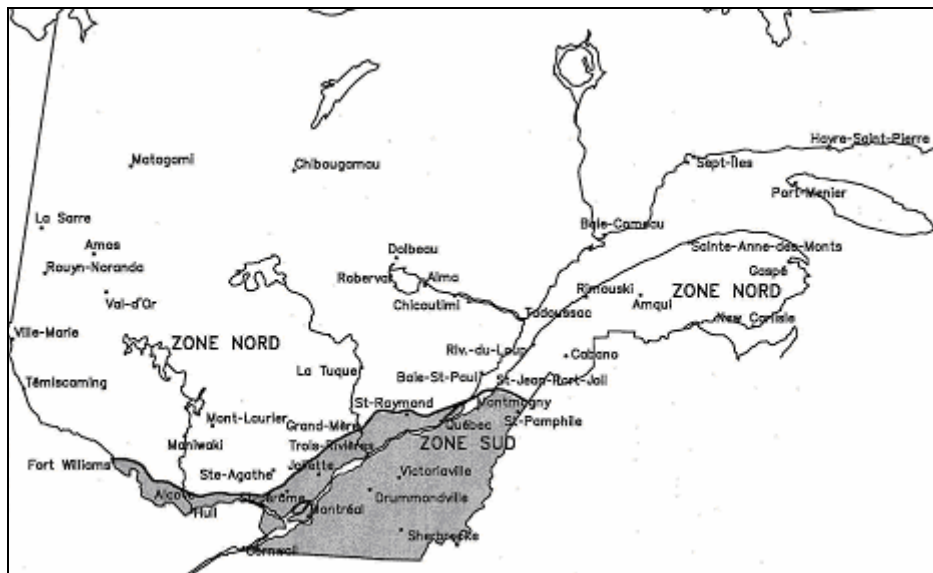
Figure 6 : Enrobé bitumineux, délimitation zone nord – zone sud
