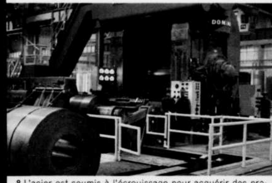
8 L'acier est soumis à l'écroissage pour acquérir des propriétés physiques, le poli de surface et la planéité convenables.
