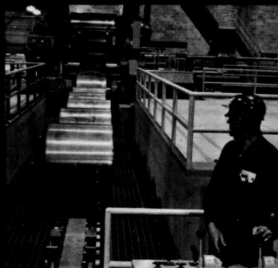
7 Après le recuit, les bobines vont au train d'écroissage.
