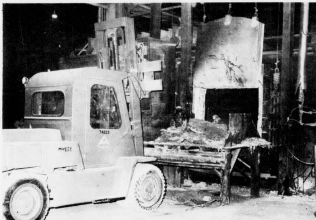
Les débris d'aluminium sont chargés dans le four du centre de récupération; ceux-ci seront bientôt transformés en métal en fusion.
