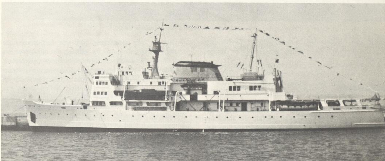
C.S.S. BAFFIN. Navire hydrographique canadien de 3,460 tonnes mesurant 270 pieds de longueur. Ce navire possède un équipage de 82 hommes et peut accommoder 22 océanographes. Sa coque renforcie et de forme spéciale lui permet de se frayer un chemin dans la glace. On distingue à la poupe la plage d'atterrissage et le garage pouvant abriter deux hélicoptères. (Photo Georges Drapeau)
