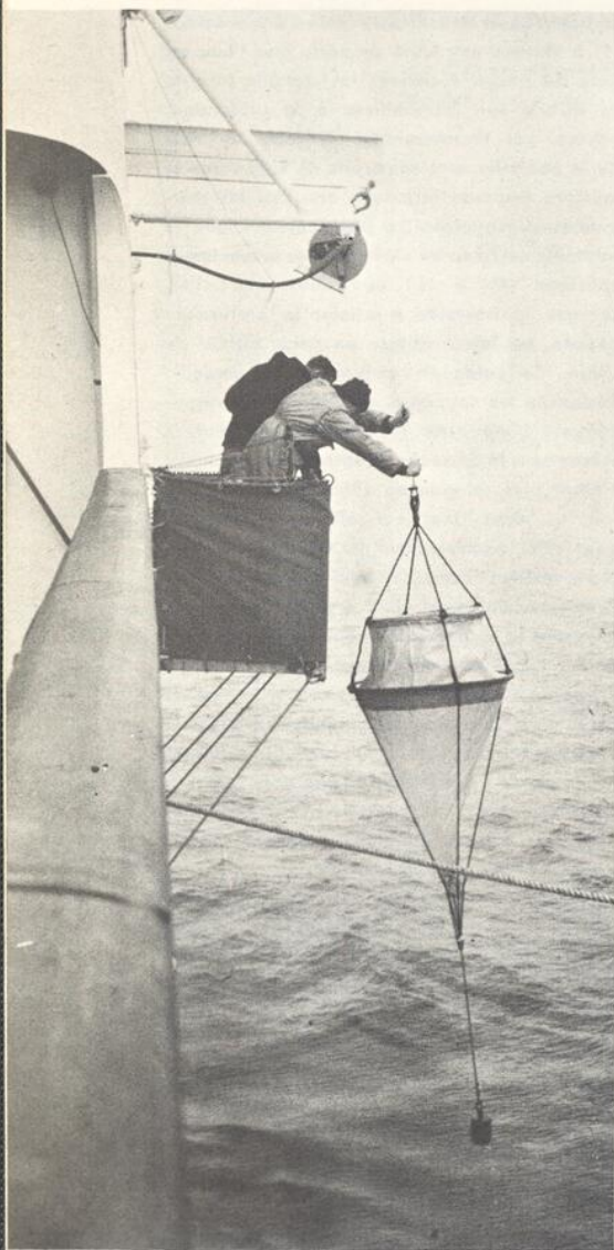
Filet Hensen. Ce filet mesure 28.8 pouces de diamètre sur 71 de longueur. Les organismes capturés sont retenus par un filtre de nylon très fin à la pointe du cône. (photo Georges Drapeau) Photo 3.
