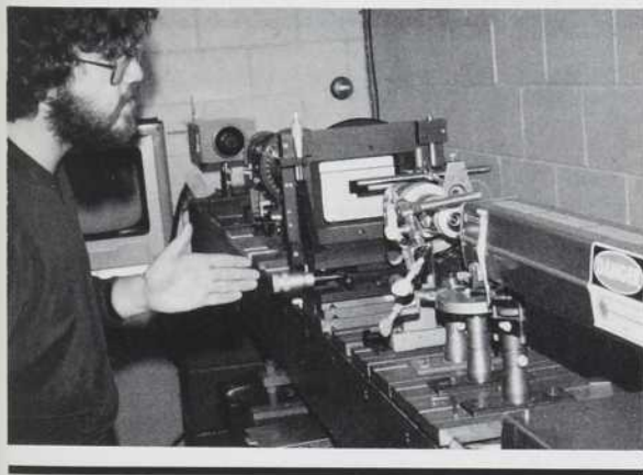
Au LROL, un étudiant au doctorat explique le fonctionnement du corrélateur optique. Cet appareil est utilisé dans des recherches sur le traitement des images.
