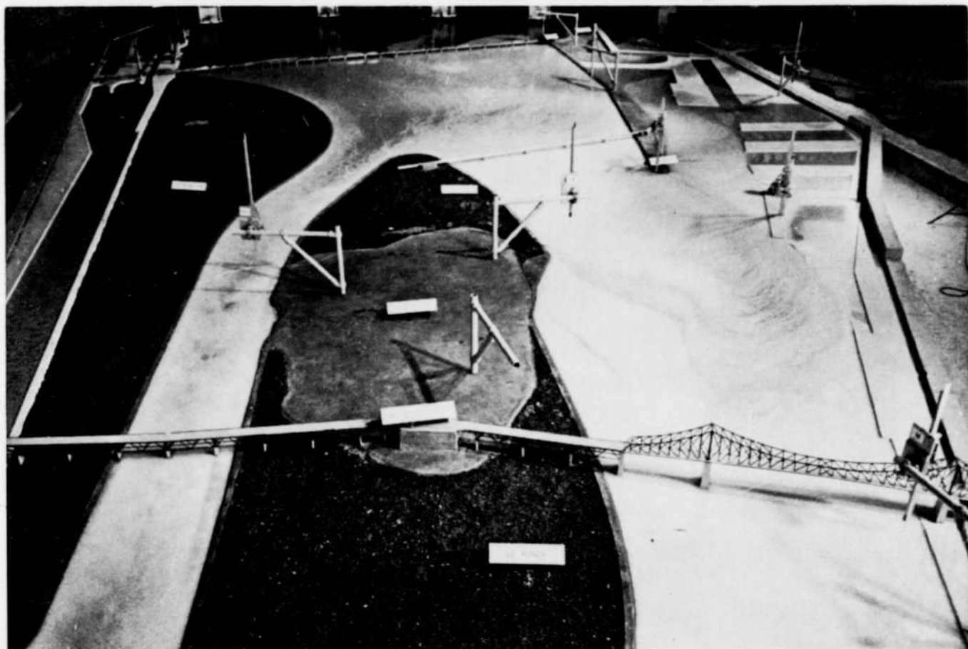
Cité de Montréal — Exposition Universelle 1967 — Simulation des conditions d'hiver Formation du couvert de glace — Débit 300,000 p.c.s.
