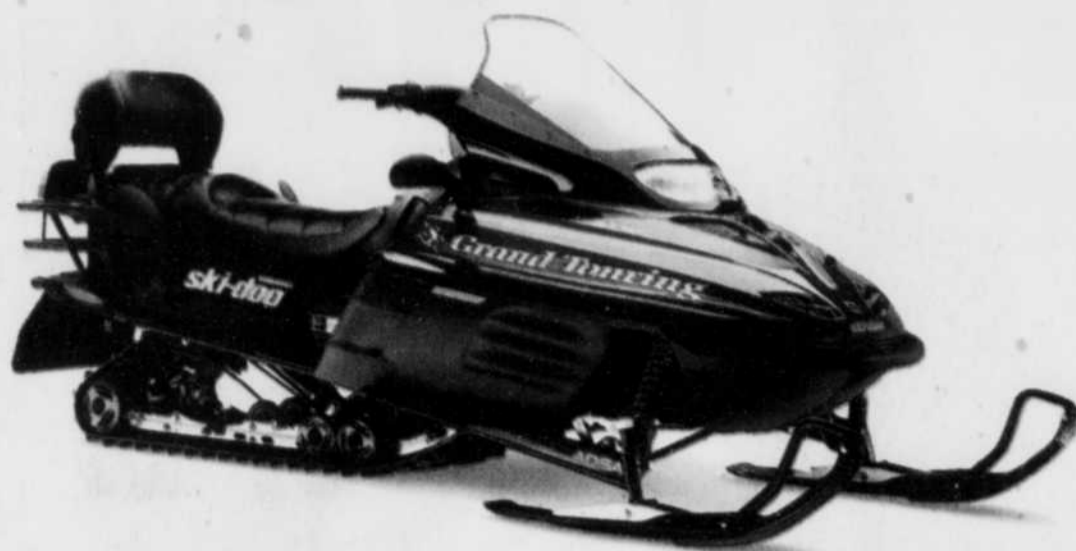
Avec son moteur trois cylindres Rotax de 796 cm 3 refroidi par liquide, la Bombardier Grand Touring SE est à l'avant-garde de la technique actuelle.
