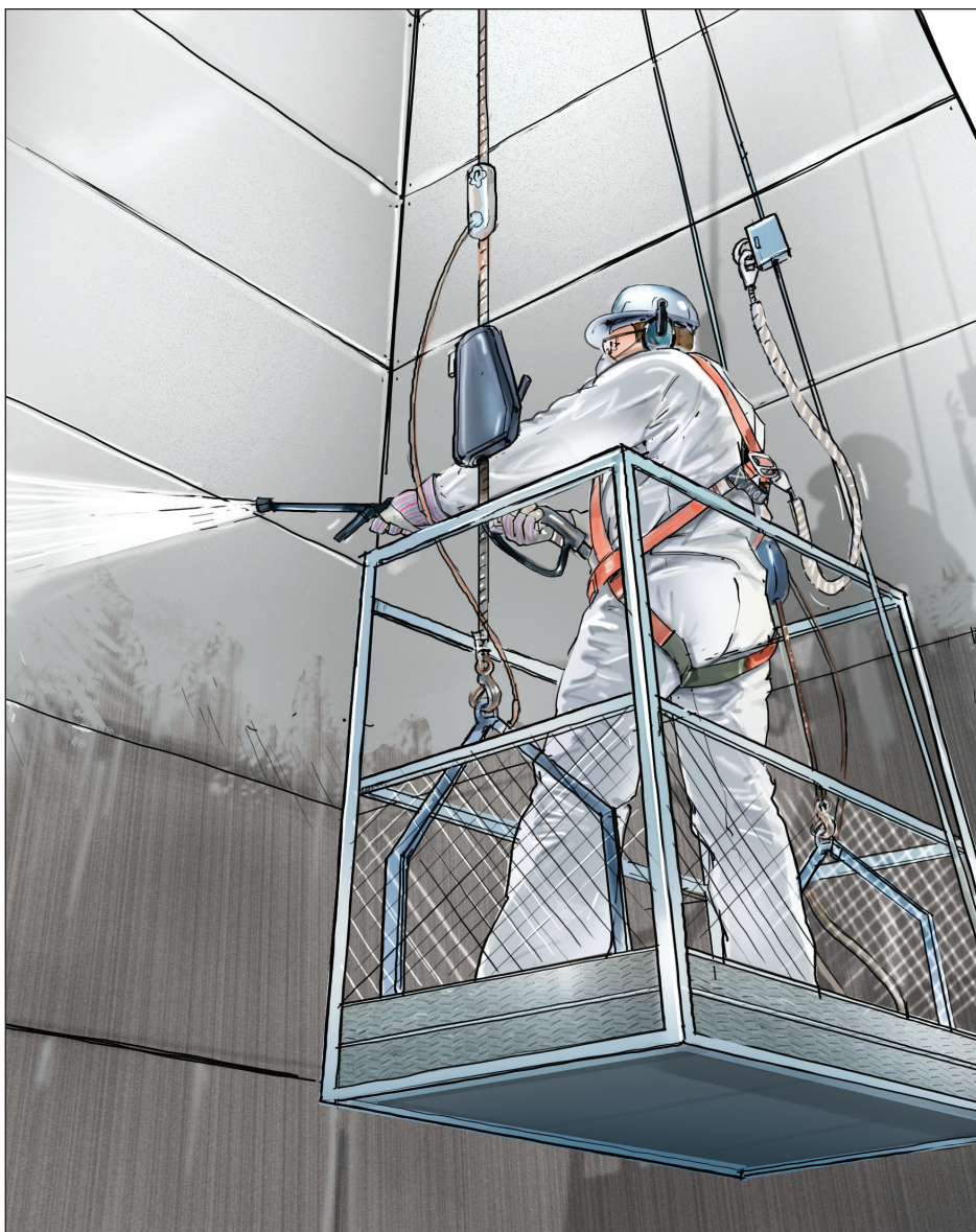
Figure 3 : Travail en hauteur avec échafaudage volant
