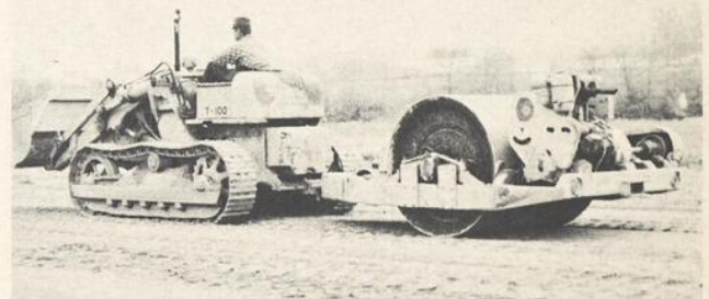
Un rouleau vibreur Vibro-Plus remorqué par un tracteur Allis-Chalmers HD-6G dans une zone de remblayage.
