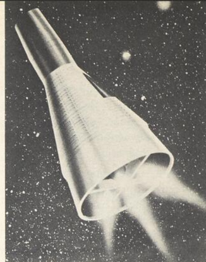
FREINAGE. La Gemini s'est détachée de l'Agna et a rejeté la section de l'équipement. Après avoir basculé de 180°, les rétro-fusées sont mises à feu pour amorcer la rentrée dans l'atmosphère.
