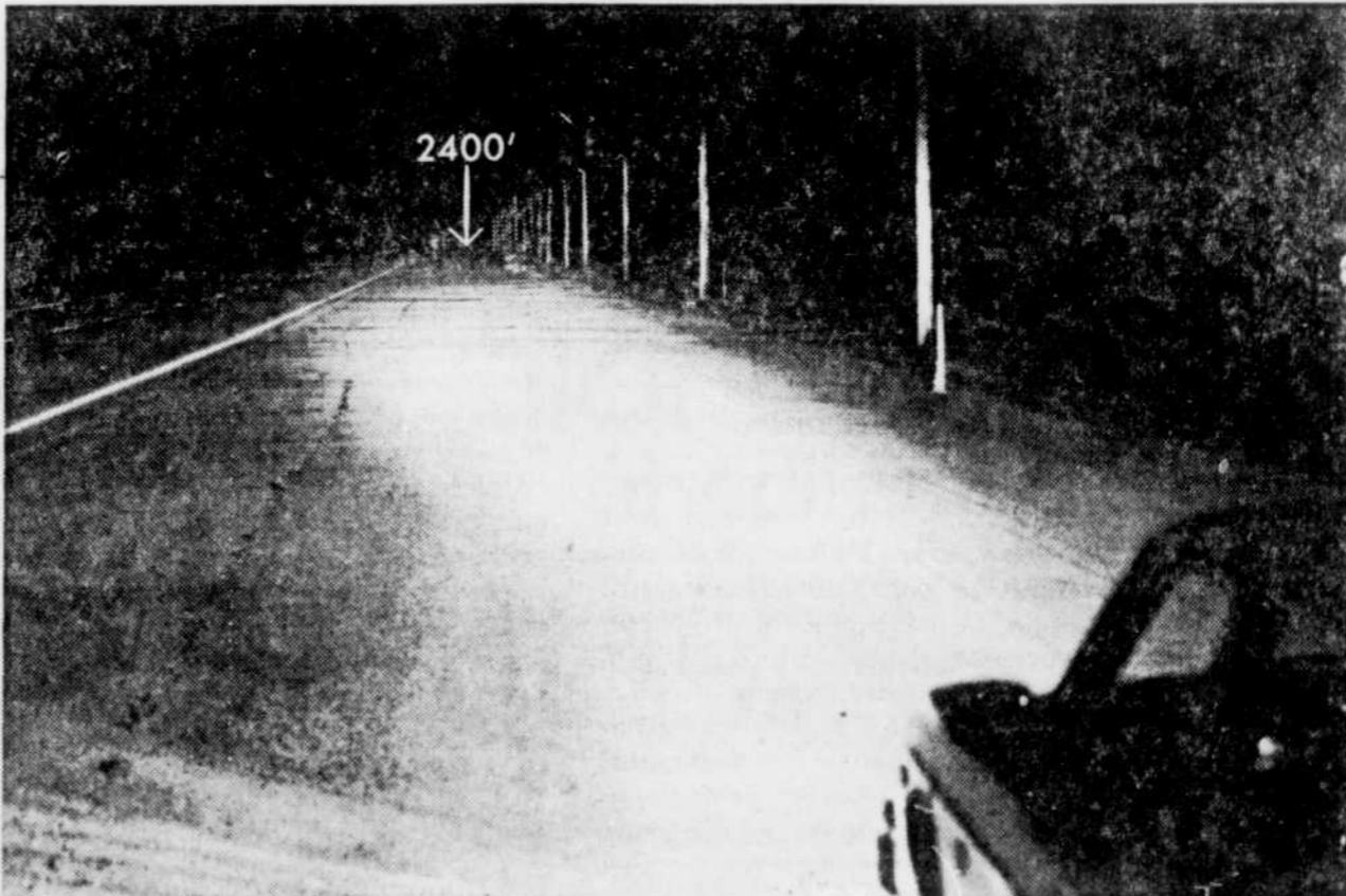
Phares Bosch SBQ—faisceau de route: Les phares Bosch SBQ, alimentés par une batterie chargée sous la même tension, éclairent beaucoup plus loin que les phares ordinaires en position faisceau de route. La visibilité, lors de cet essai, était bonne jusqu'à 2,400 pieds.
