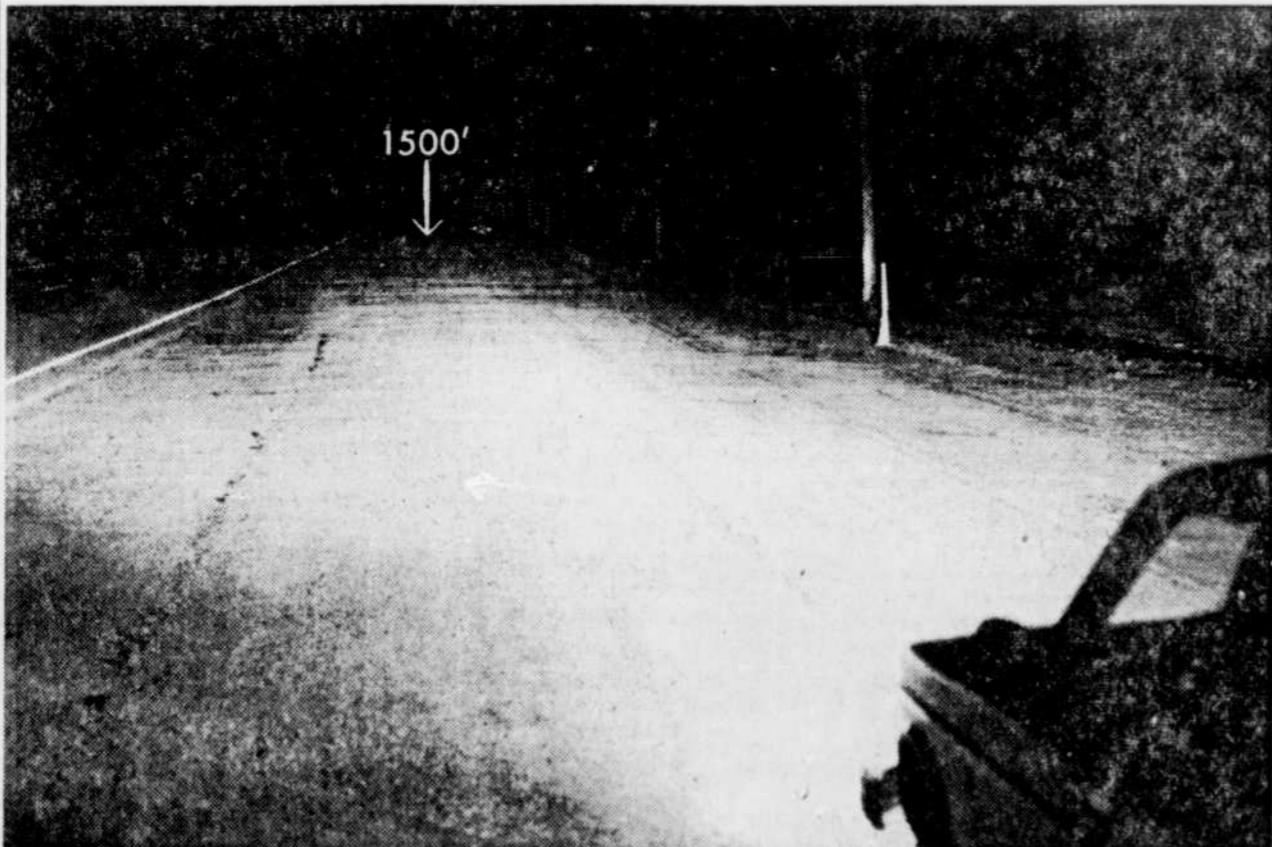
Phares ordinaires—faisceau de route: En position faisceau de route, les phares ordinaires éclairent à peine la voiture qui est stationnée, plus loin, sur le côté droit de la route. (Les poteaux télégraphiques sont espacés de 150 pieds.)
