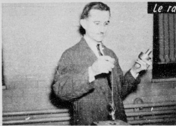
Les élèves de l'École Technique de Montréal se servant du radium pour examiner les métaux qu'ils coulent eux-mêmes. C'est la seule école technique au Canada à posséder du radium: un millième d'once. Ci-dessus, M. Fernand Rainville, technicien en radiographie et diplômé du Laboratoire National de Recherches d'Ottawa, remet la capsule de radium dans son coffret de plomb.
