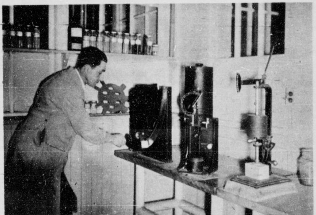
Le sable, dont seront garnis les moules, est pesé pour contrôler son degré d'humidité. M. C.-H. Poiré dirige cette opération. (Photos E. Stucker, la "Patrie").
