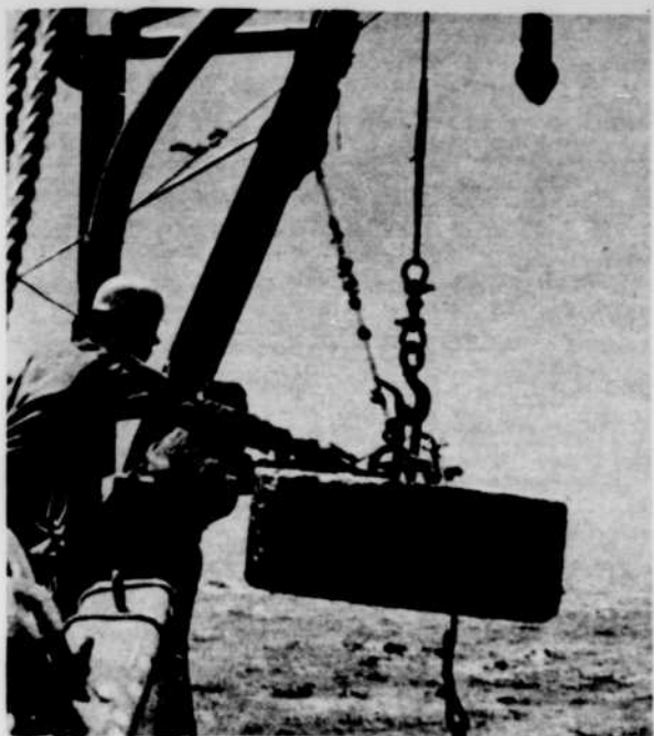
immergée au fond pour maintenir la station hydrographique.
