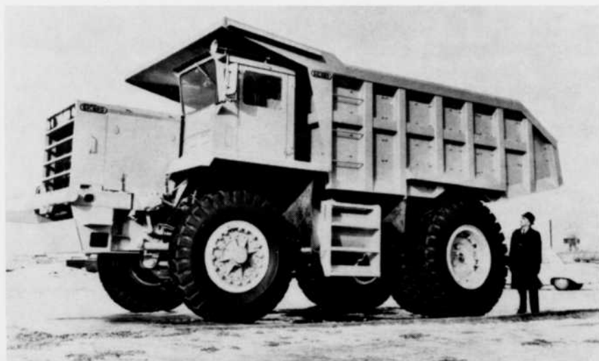
Le camion de 65 tonnes Sicard - KW - Dart. Les pneus mesurent 6'8" et pèsent 1,590 chacun.
