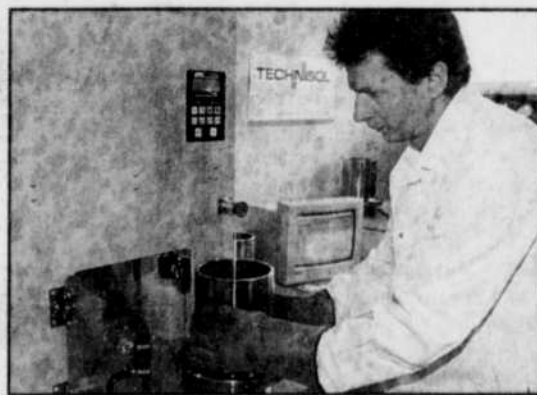
Technisol s'est doté récemment d'une presse à cisaillement giratoire permettant d'évaluer l'aptitude au compactage des mélanges bitumineux.
