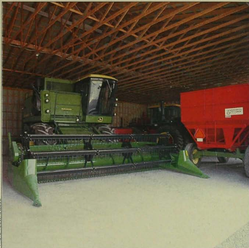
Avant l'hiver les machines agricoles doivent être complètement nettoyées afin d'éviter la rouille durant l'entreposage.
