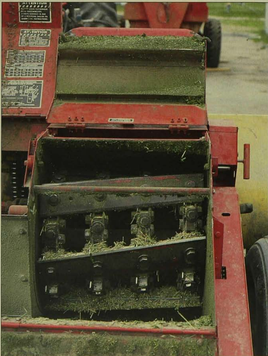
Tambour hacheur avec la moitié des couteaux enlevés pour hacher plus long.
