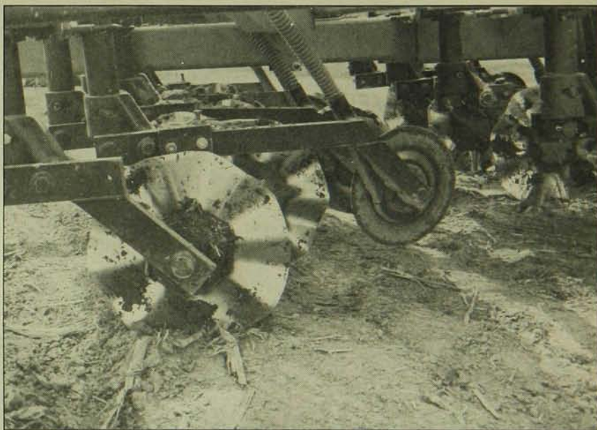
Ces couteurs ondulés, de 2 pouces de largeur, tranchent les résidus et les poussent de chaque côté du rang.
