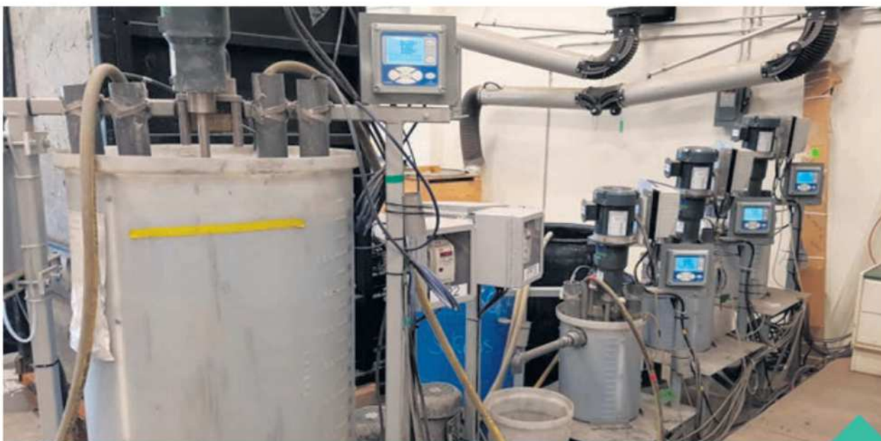
Des travaux en laboratoire (flottation) ont démontré qu'il est possible d'utiliser les rejets miniers, qui n'ont aucun potentiel de contamination, pour remplacer des sols naturels. Photo Gracieuseté - UQAT
