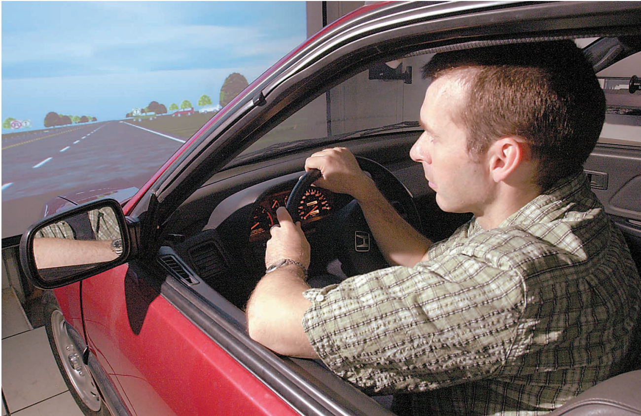
Un puissant ordinateur, celui-là même que l'on emploie pour la réalisation d'effets spéciaux cinématographiques, anime l'écran et analyse toutes les actions et réactions du conducteur.
