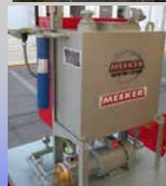
Injecteur pour Asphalte Tiède
