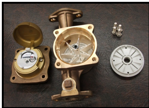
Figure 5-6 - Composantes d'un compteur à jet unique
