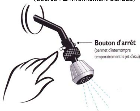
Figure 4-3 - Pomme de douche à faible débit avec bouton d'arrêt
