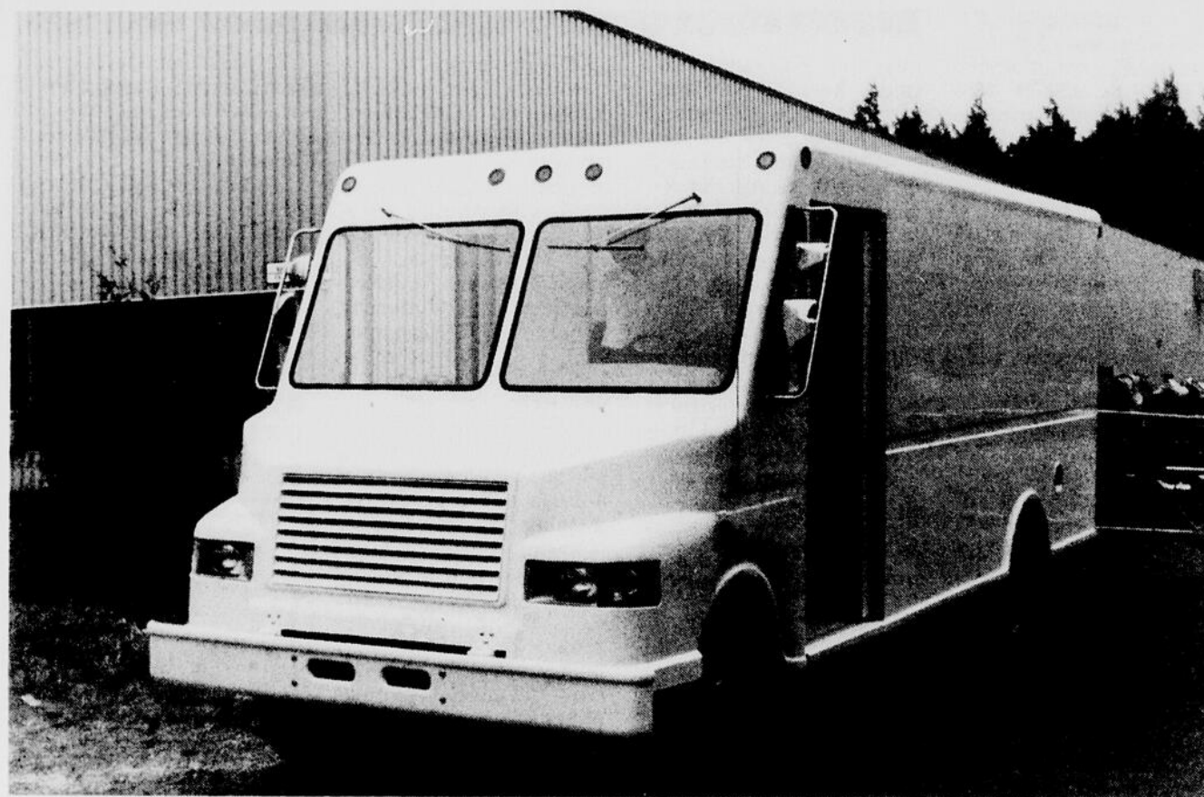
Le MAX, fabriqué à Bromont. Ce véhicule, constitué de fibres de verre, pourrait être distribué partout en Amérique par la compagnie International.
