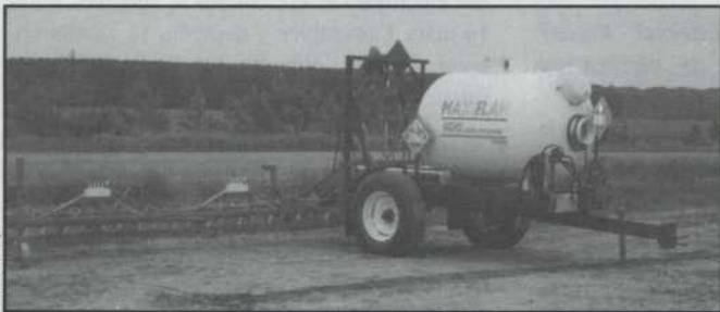
Prototype pré-commercial d'une portée de 10 rangs montrant l'aspect général d'un équipement employé en lutte thermique.
