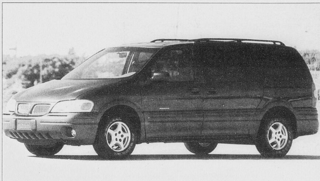
TRANSFORMATION - En 1997, la Trans Sport a vu ses panneaux de polymère remplacés par une construction plus classique en métal. Au chapitre de la motorisation il n'y a désormais qu'un seul moteur soit un V6 de 3.4 litres.
