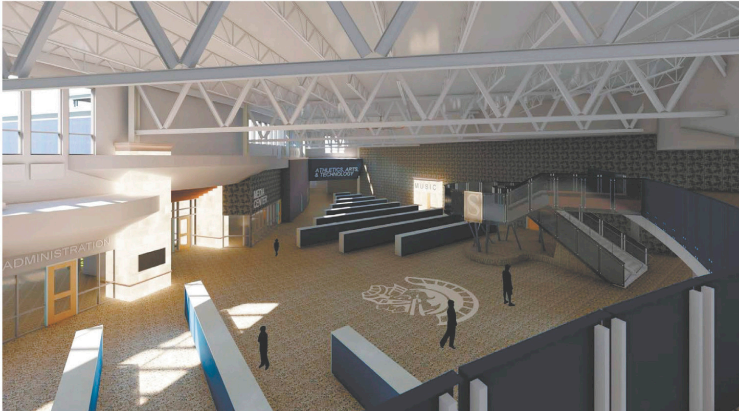
La future école secondaire de Fruitport aura dans son hall d'entrée des murs de béton pour permettre aux élèves de se protéger d'un éventuel tireur. De plus, ses corridors seront incurvés pour réduire au maximum les lignes de tir et donc les cibles potentielles. MICHIGAN TOWERPINKSTER
