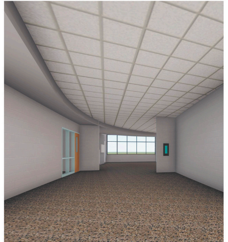
La future école secondaire de Fruitport aura dans son hall d'entrée des murs de béton pour permettre aux élèves de se protéger d'un éventuel tireur. De plus, ses corridors seront incurvés pour réduire au maximum les lignes de tir et donc les cibles potentielles. MICHIGAN TOWERPINKSTER
