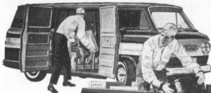
CORVAN: Les portes latérales ont une ouverture totale de 49" de largeur. La plate-forme n'est qu'à 14" du sol!
