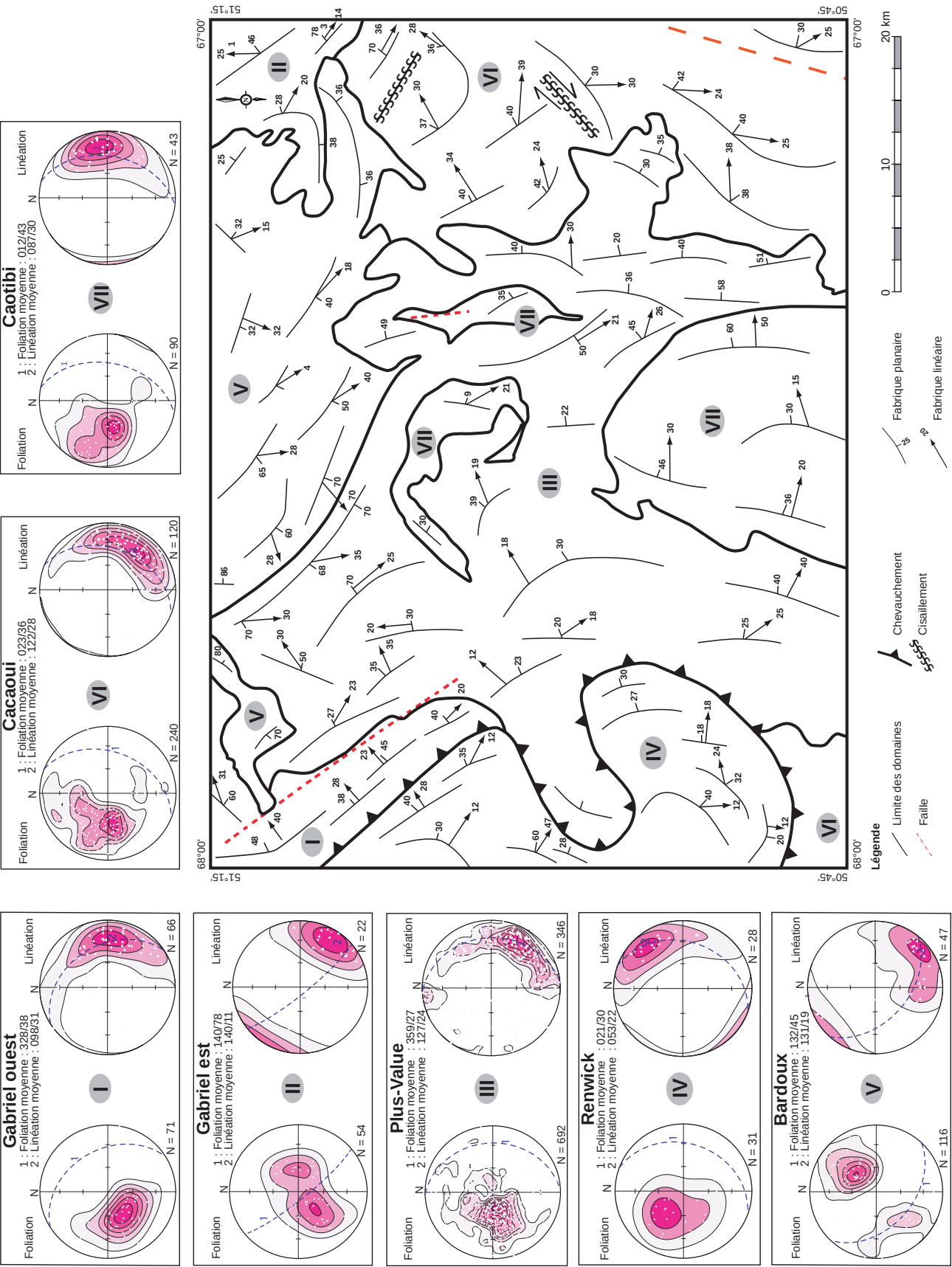
FIGURE 6 - Analyse structurale appliquée à la région étudiée, limites des domaines structuraux et projections stéréographiques des fabriques planaires et linéaires, effectuées selon le canevas de Wulff dans l'hémisphère inférieur.
