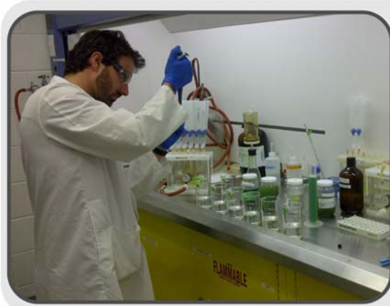
Technicien du CEAEQ procédant à l'analyse des cyanotoxines à l'étape de l'extraction de celles-ci (source : C. Deblois, CEAEQ)
