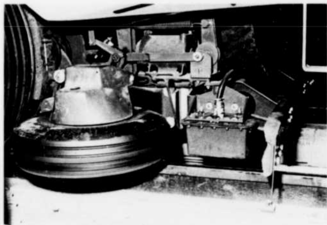
Figure 5 — Capteur surplombant le rail.
