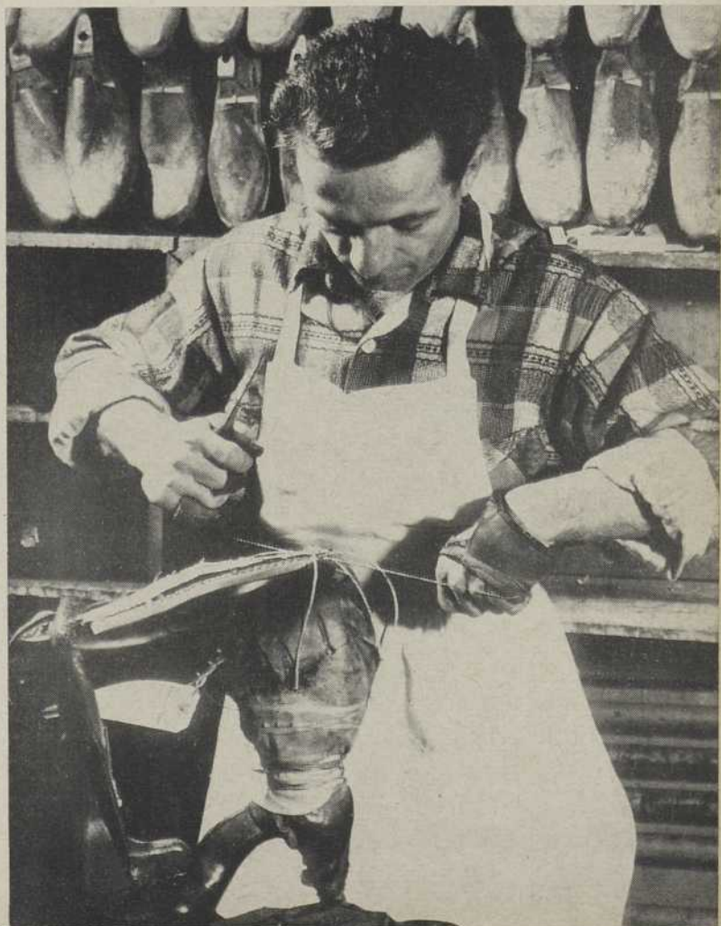
La trépointe est maintenue en place par un gros fil fait de quinze brins de grosseur normale tordus ensemble. On essaye actuellement le fil de nylon pour faire cette couture.
