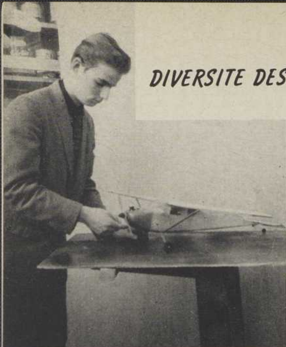
M. CLAUDE FOREST, ETUDIANT EN PREMIERE SPECIALISATION AU COURS TECHNIQUE, PROCEDE A LA MISE AU POINT DU MOTEUR "COX BABY BEE 049", D'UN "CESSNA 180" A ECHELLE REDUITE.
