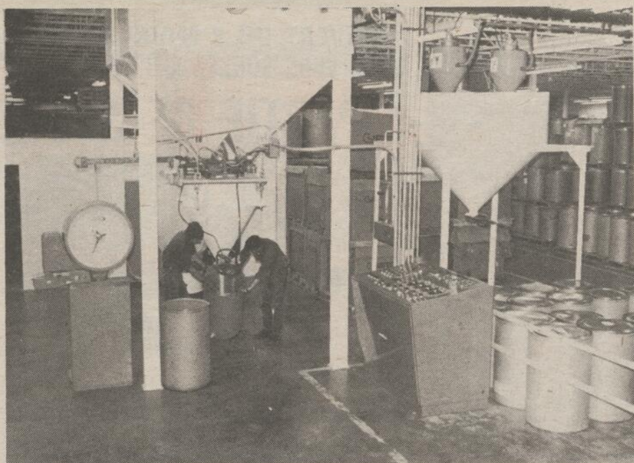
Salle des mélanges. C'est dans cette salle que les poudres qui formeront une fois injectées et chauffées dans les moules les contenants Tupperware, sont dosées et mélangées automatiquement. On voit ici un des spécialistes à l'oeuvre devant son tableau de contrôle.
