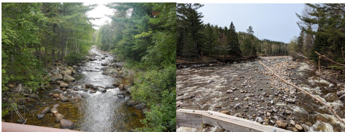
Figure 64. Pont privé de la rue du Bras à Saint-Urbain. Photos obliques en direction de l'amont de la rivière avant l'événement (24 août 2022) et après l'événement (8 mai 2023). Changement du style fluvial de linéaire (seuils-mouilles) à divagant. Changement dans le calibre des sédiments du lit : avant, composé de blocs pluridécimétriques à métriques avec peu de sédiments fins; après, composé de blocs décimétriques avec sables et graviers sous forme de plusieurs bancs d'accumulation
