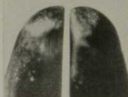
Autre Marque No 3—Les sommets sont usés sur toute la surface écrivant. Le bout de droite est aplati et creusé.
