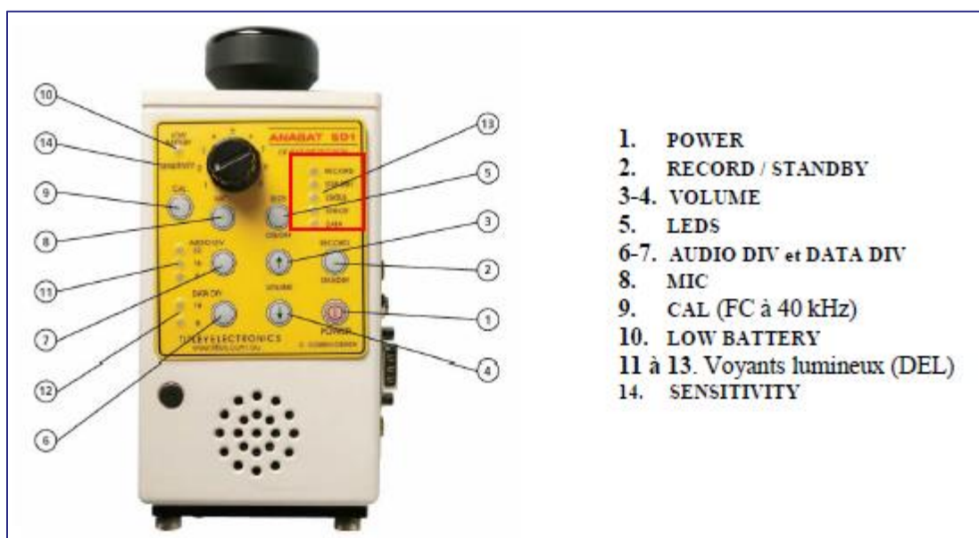
Figure 1. Détecteur Anabat SD1, vue de face et identification de ses composants (le système SD2 est très similaire)
