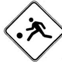
D-270-3 Signal avancé de passage pour enfants près d'un terrain de jeux
