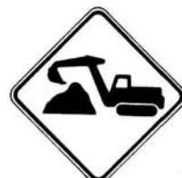
T-50-4 Travaux mécanisés
