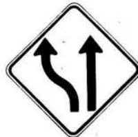
T-110-3-G Déviation d'une voie à gauche
