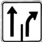
P-100-6-D Voie de gauche: aller tout droit Voie de droite: tourner à droite
