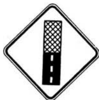
D-340 Changement dans l'état d'une chaussée
