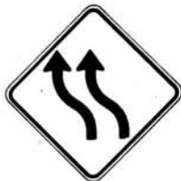
T-110-2-G Déviation de 2 voies à gauche
