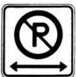
P-150-1 Stationnement interdit
