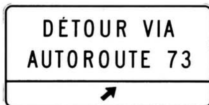
T-90-3 Détour Via
