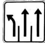
P-100-8-G Voie de gauche: tourner à gauche Voie centrale: aller tout droit Voie de droite: aller tout droit
