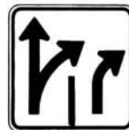
D-100-7-D Signal avancé de direction des voies
