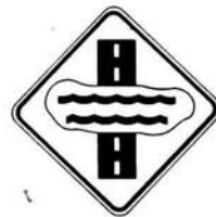
D-330 Chaussée inondée
