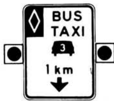
D-250-1 Signal avancé de voie réservée
