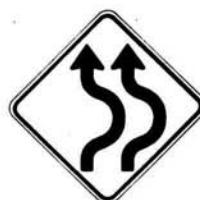
T-110-5-D Déviation de 2 voies à droite
