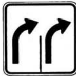
D-100-11-D Signal avancé de direction des voies
