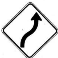
T-110-1-D Déviation de voie à droite
