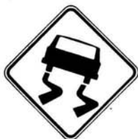
D-310-1 Chaussée glissante
