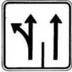
D-100-9-G Signal avancé de direction des voies
