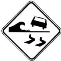
D-310-3 Chaussée glissante à cause des embruns
