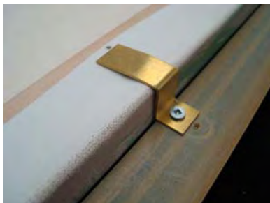
Plaque de métal épousant la forme du châssis et du cadre.
