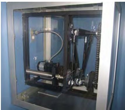
Détail : la pose d'un boîtier transparent autour des composantes technologiques de cette sculpture cinétique est un excellent moyen de les protéger contre la poussière, l'humidité et le vandalisme.
