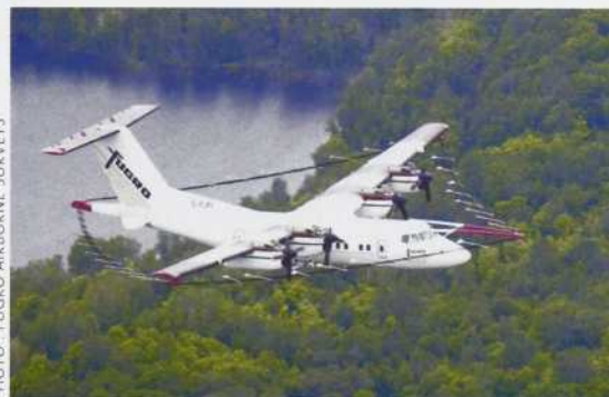
Système de mesure électromagnétique aéroportée MEGATEM. La photographie met en évidence le porteur (Dash-7) et la boucle de courant entourant le porteur.
