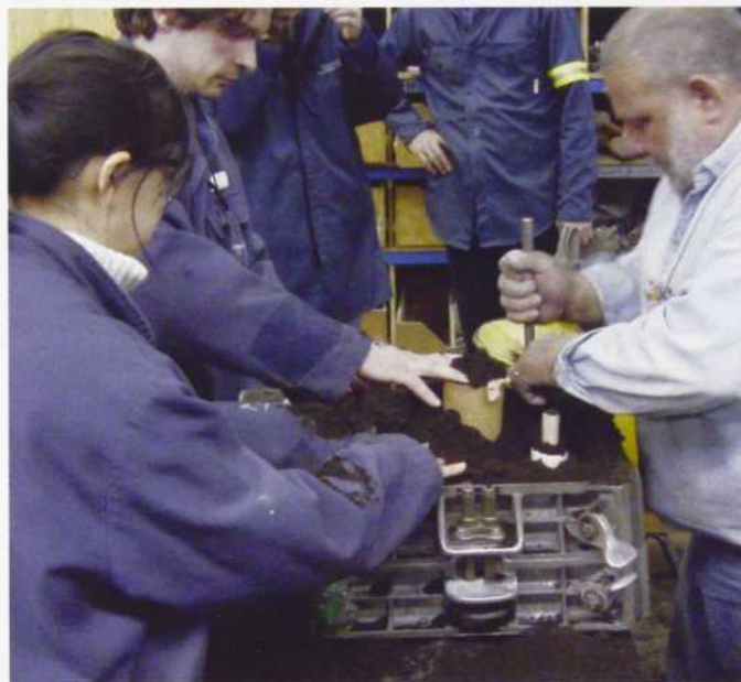
Conception de moules en sable pour la fabrication des centres de roues de la formule SAE lors de la journée étudiants du REGAL.
