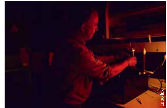
Le travail en laboratoire de luminescence se fait en lumière tamisée et filtrée pour longueur d'onde se rapprochant de l'orange.
