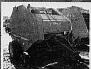
Presse à balles rondes Deutz GP250, chambre fixe, balles de 4x4, éjecteur de balles, relevage pick-up hydro. La Pocatière Tag: 00954
