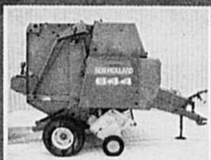
Presse à balles rondes New Holland 644, corde et filet, ball slice, cylindre sur ramasseur. Rivière-du-Loup Tag: 0829E
