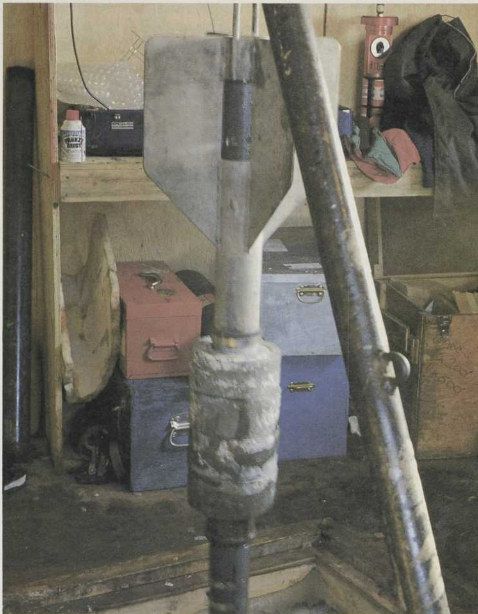
Le carottier à gravité permet de prendre des échantillons des sédiments du fond marin pour déterminer la composition et évaluer l'âge de ces sédiments.
