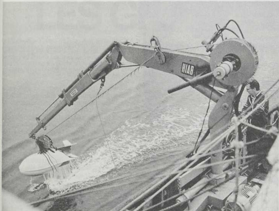
◁ POUR ESPIONNER LES POISSONS — Un petit submersible, porteur d'un radar acoustique, est remorqué par un chalutier. Il contient un émetteur dirigé vers le fond et des récepteurs acoustiques pour capter les échos renvoyés par les habitants du fond de la mer.
