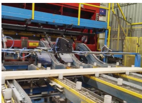
Figure 4 : Appareillage d'identification d'essences de bois résineux par proche infrarouge
