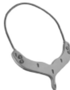
Figure 3 Implantation d'un système directionnel à multimicrophones sur un collier
