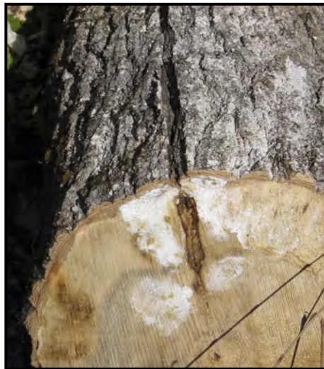
Figure 31 ▼ Découpe transversale d'une fente droite profonde et pourrie
