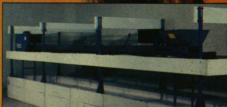
Le convoyeur à courroie Patz achemine vite la nourriture dans un sens tandis qu'un dispositif novateur la distribue uniformément dans les mangeoires.
