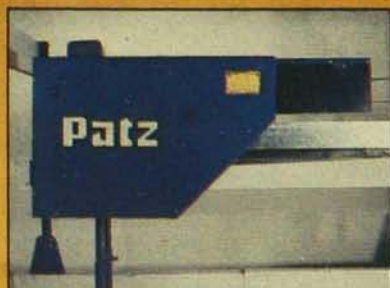
Un même moteur actionne la courroie et le dispositif distributeur, sans besoin de moteur à inverser.
