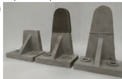
Fig. 2: Dans l'ordre; demi-pièce coulée, réparation par DED, pièce complète coulée
