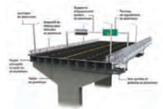
Fig. 3 : Exemple d'un pont à platelage en aluminium
