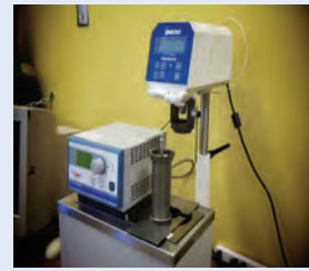
Fig 3. Brookfield R/S plus rheometer
