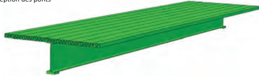
Fig. 4 : Exemple de modélisation d'un pont à platelage en aluminium sur poutres d'acier
