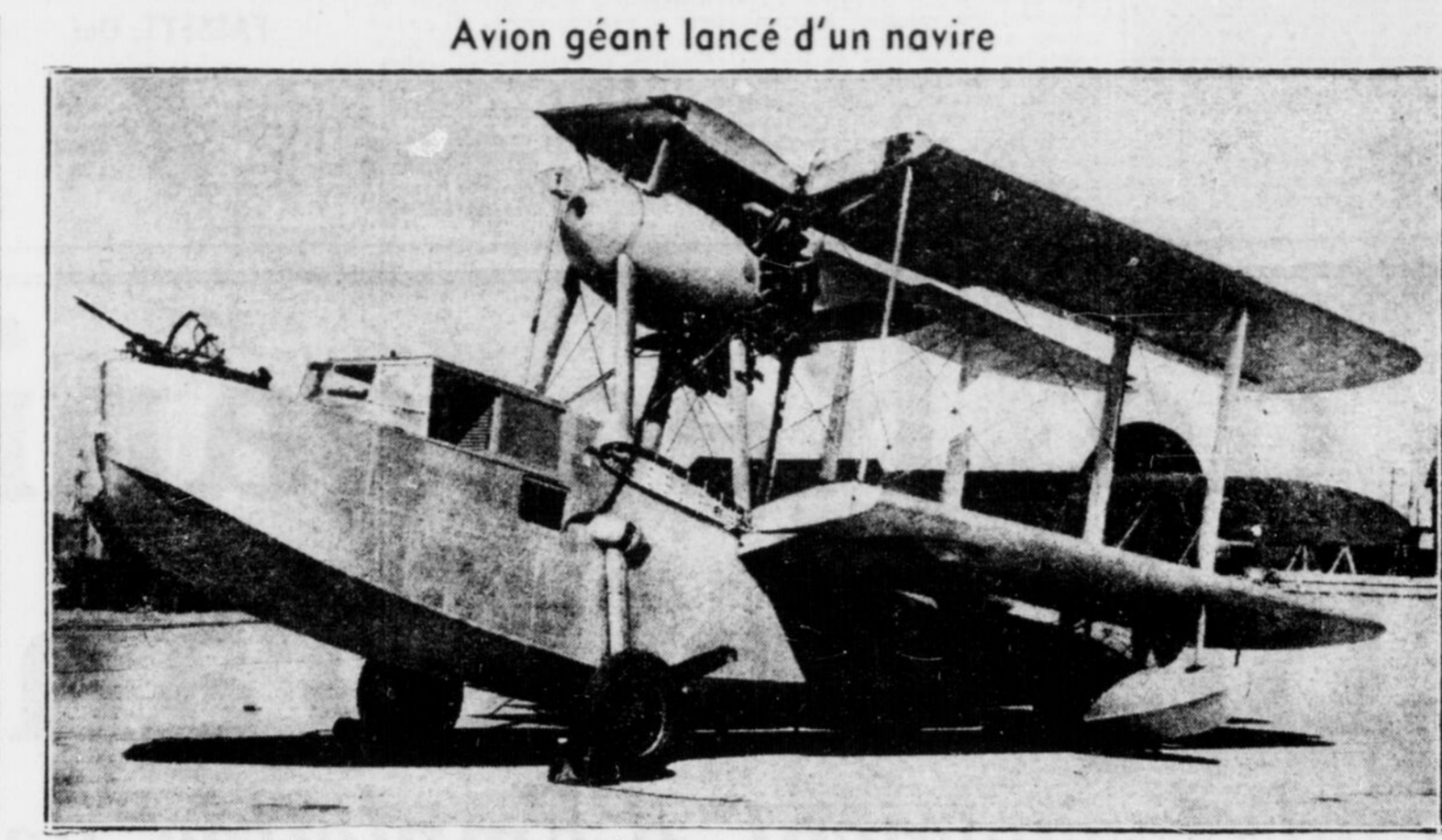
Un exploit sans précédent dans l'aviation moderne a été accompli récemment aux établissements Royal Aircraft, à Farnborough, Hants. Un hydroavion géant a été lancé dans les airs par un puissant catapulte construit spécialement pour la circonstance. On voit ici l'hydroavion "Seagull Mark V" qui sera affecté aux reconnaissances. Ses ailes sont repliées en ce moment.
