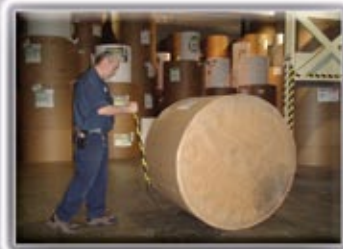
Solisco a conçu un levier pour faciliter la manipulation des rouleaux de papier.
