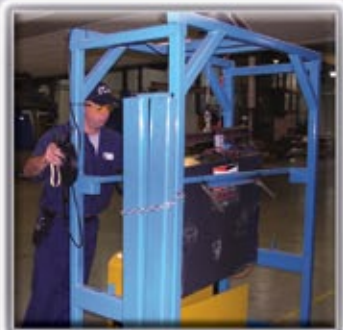
Transcontinental Métropolitain a mis au point un système de levage pour la manipulation des batteries des transpalettes électriques.
