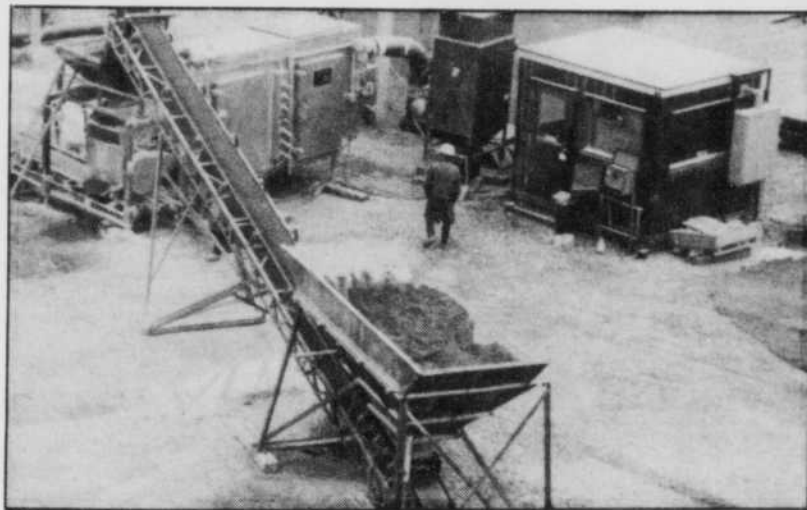
Un séchoir-convoyeur pour matériaux granulaires mis au point par le secteur des Électrotechnologies industrielles.
